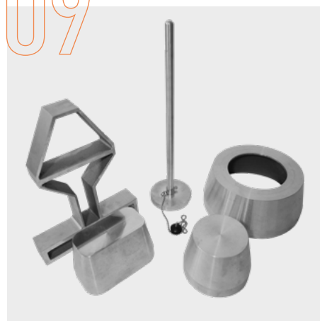
НАБОР ПОВЕРОЧНЫХ ИНСТРУМЕНТОВ ДЛЯ ПРОВЕРКИ БЕЗОПАСНОСТИ Включает все инструменты допускного контроля: щупы, стержни-пальцы, шаблон и др. Упакован в специальный чемодан для удобной транспортировки.
