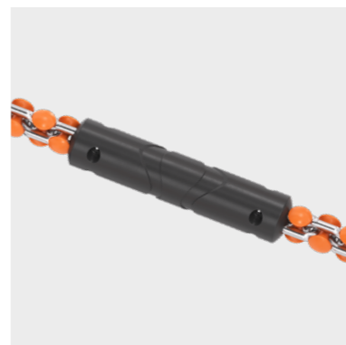
28 РУЧКА ДЛЯ ЦЕПИ Полиамид Предназначена для круглоз- венной цепи 6x19 мм (DIN766).
