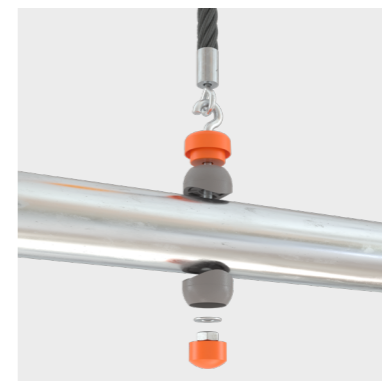
21 «КАНАТ-КРЮК-ТРУБА» Сталь, сополимер полипропилена, армированный канат Соединение каната Ø16 мм с трубой ДУ25 с помощью обжимной втулки, звена цепи и стального крюка.
