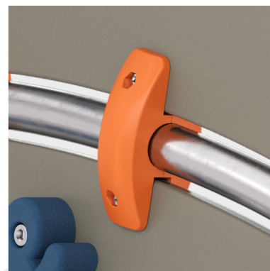
30 СОЕДИНИТЕЛЬ «HDPE-ТРУБА» Стеклонаполненный полиамид Предназначен для крепления трубы ДУ25 к двум листам HDPE-пластика (15 мм).
